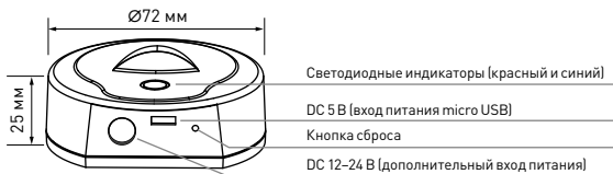
Рис. 1. Назначение индикаторов и кнопок на корпусе конвертера
