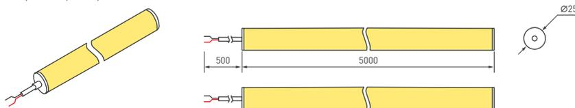
Вывод кабеля питания выполнен с одной стороны вдоль линии сечения «неона». Длина кабеля питания 500 мм.
