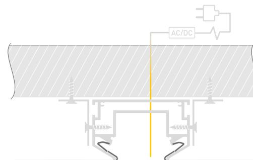
Установить шинпровод в профиль-держатель. Подключить шинпровод и подвесить светильники.
