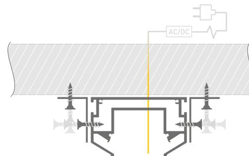
Закрепить полотно натяжного потолка с помощью гарпуна к профилю-держателю.
